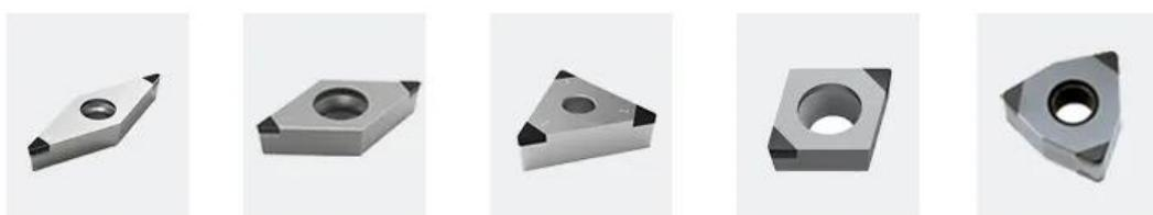
**Inserti con punta in CBN:** strato di CBN saldato direttamente al substrato ad alta temperatura e altissima pressione, con rivestimento in materiale CBN su uno o entrambi i lati e foro centrale per il posizionamento.
